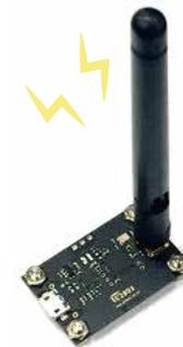
▶ 3축 가속도, 3축 지자기, 3축 자이로스코프 센서를 통해 회전기계 및 구동하는 설비의 진동을 측정하여 이상 진동에 따른 사전 예측/예방을 실현합니다.
